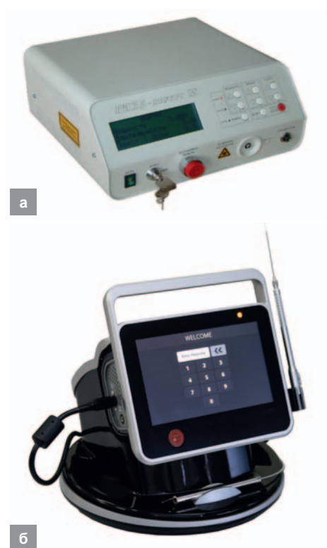
Рис. 9. Лазерные аппараты для хирургии: а – «Лика-хирург-М» ( \lambda = 0,45 мкм, 7 Вт) от «Фотоники Плюс» (Украина), б – двухволновой Alta-Soyuz-Blue ( \lambda = 0,45 \pm 1,55 мкм / 13 \pm 1,5 Вт) НТО «ИРЭ-Полюс» (Россия)
