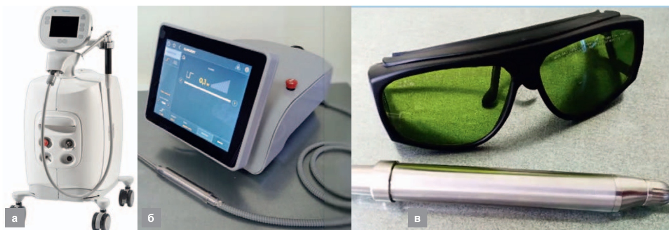
Рис. 10. Аппараты для хирургии диапазона \lambda = 3 мкм: а – «Litetouch», б – макет аппарата с ПОГ в аппликаторе, в – второй вариант аппликатора с расположенным в нем ПОГ
