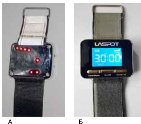
Рис. 1. Аппарат LASPOT (КНР): А – излучатель поверхности; Б – панель управления
