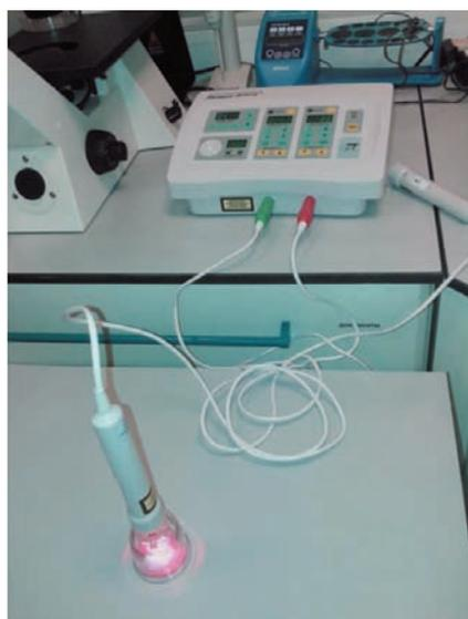
Рис. 2. Расположение лазерных излучающих головок относительно чашки с культурой клетки МСК
