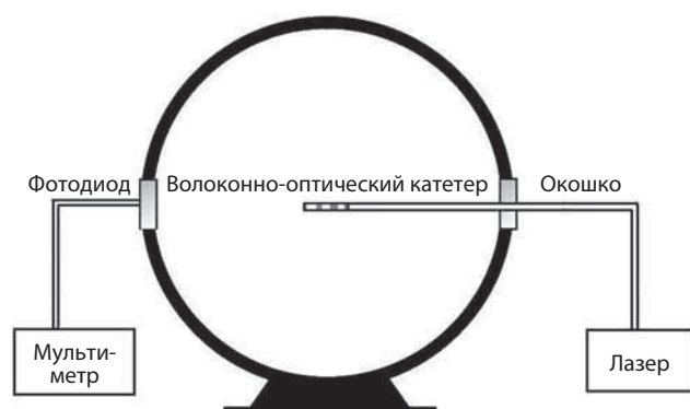
Рис. 6. Схема фотометрической сферы
